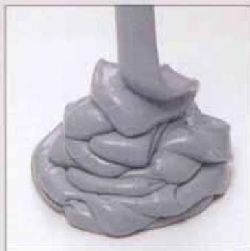
スリーボンド1215は、シリコーンを主成分とした半乾性粘弾型の液状ガスケットです。常温で空気に触れると硬化しゴム状の弾性体を形成します。セミスランプ性で、流動性が良好にもかかわらず、肉盛性に優れていますのでクリアランスの大きい接合面のシールにも効果を發揮します。また耐熱性に優れていますので高温のかかる接合面のシールにも威力を発揮します。無溶剤ですので労働安全衛生法に基づく有機溶剤中毒予防規則を配慮する必要がなく、安心して使用できます。
