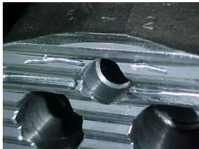
Crack removed. クラック除去後。
